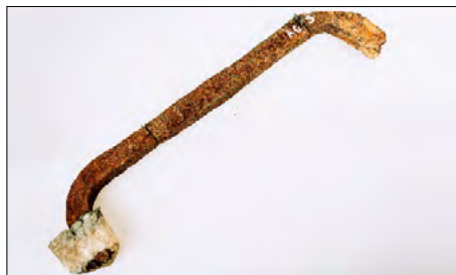
Staple from the Notre-Dame de Paris construction site, after sampling © Cyril FRESILLON / IRAMAT / NIMBE / ArScAn / CEA / Chantier Scientifique Notre-Dame de Paris / Ministère de la culture / CNRS
